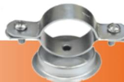
Uma abraçadeira é uma peça utilizada para fixar tubulações, cabos ou outros elementos, mantendo-os em uma posição específica. Essa abraçadeira é composta por uma banda de aço galvanizado em forma de U, que se encaixa ao redor do elemento que será fixado e um parafuso que permite apertar e prender a banda de aço.
