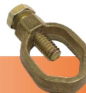
Um conector de pressão para haste terra é um componente utilizado para conectar a haste terra a um cabo condutor que conduzirá a corrente elétrica para o sistema de aterramento. Ele é composto por duas partes principais: uma parte em forma de U que se encaixa na haste terra e uma outra parte que se encaixa no cabo condutor. Essas duas partes são unidas por meio de uma porca ou parafuso, formando uma conexão segura e confiável.
